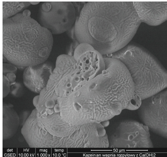
Fot. 2. Mikrostruktura kazeinianu wapnia otrzymanego metoda zbiornikową. Fig. 2. Microstructure of calcium caseinate produced by a tank method.
