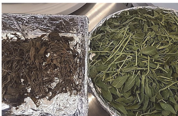
Fot. 1. Wygląd materiału roślinnego po suszeniu konwencjonalnym i po liofilizacji Photo 1. Appearance of plant material after conventional drying and lyophilisation
