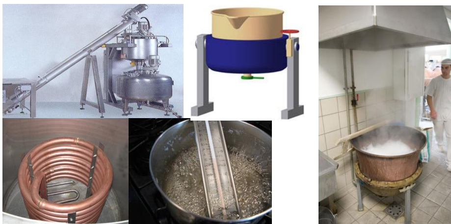
Ryc. II.4. Urządzenia do otrzymywania syropu karmelowego metodami periodycznymi (otkryte kotły warzelne, o różnej konstrukcji) Źródło: Hadjikinov, 2005.
