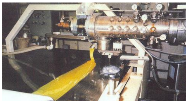
Ryc. II.9. Schemat i wygląd ogólny aparatu próżniowego do ciągłego gotowania masy karmelowej
