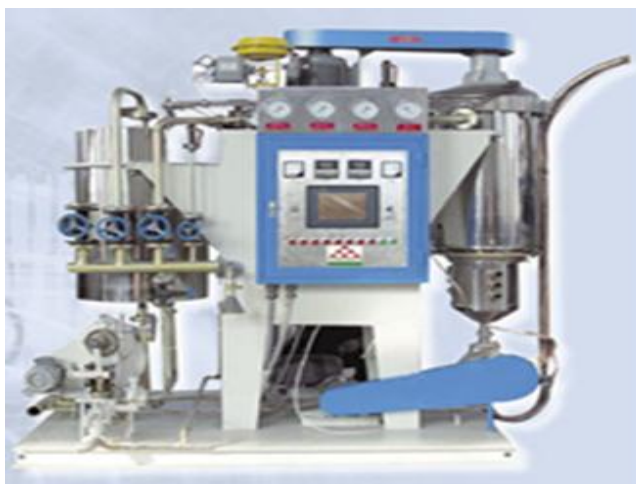
Ryc. II.8. Schemat i wygląd ogólny cienkowarstwowego aparatu do gotowania masy karmelowej
