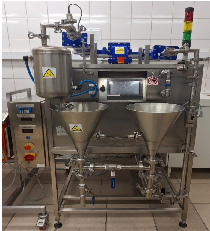
Rycina 1. Przepływowy pasteryzator mikrofalowy do produktów płynnych W0314 (Weindich SP.J.) znajdujący się na Wydziale Technologii Żywności Szkoły Głównej Gospodarstwa Wiejskiego w Warszawie, funkcjonujący w ramach Centrum Badawczo-Rozwojowego Żywności i Żywienia (CŻiŻ). Źródło: fotografia własna autorki.
