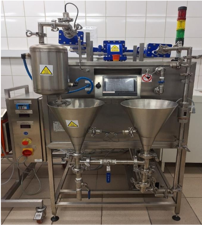
Rycina 1. Przepływowy pasteryzator mikrofalowy do produktów płynnych W0314 (Weindich SP.J.) znajdujący się na Wydziale Technologii Żywności Szkoły Głównej Gospodarstwa Wiejskiego w Warszawie, funkcjonujący w ramach Centrum Badawczo-Rozwojowego Żywności i Żywnienia (CŻiŻ). Źródło: fotografia własna autorki.
